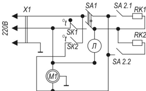
Рис.3. Схема электрическая принципиальная Тепловентилятора ТВ-3/6.
